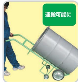
傾けると、台車の爪がドラム缶の下に入り込みます!
