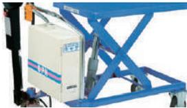
リフトの上昇スピードを自由にコントロールするのがソフトアップ機構。バッテリー式の全てに採用。ワンタッチレバー操作で、上昇下降できますので、女性や高齢者に好評です。また、デリケートな荷物の取扱いや不安定な荷物に対して最適の機能です。
