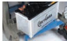
バッテリーブラケット ブラケットの位置を変える事で、簡単にメンテナンスができます。
